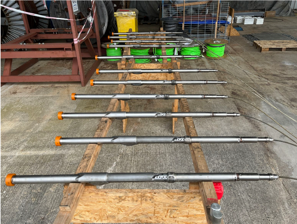
Bild 2: Für die Injektion werden Rohre in ein Bohrloch eingeführt und verschraubt. Dies geschieht mit einer Anlage, die „Pipehandler“ heißt. Foto: GFZ
