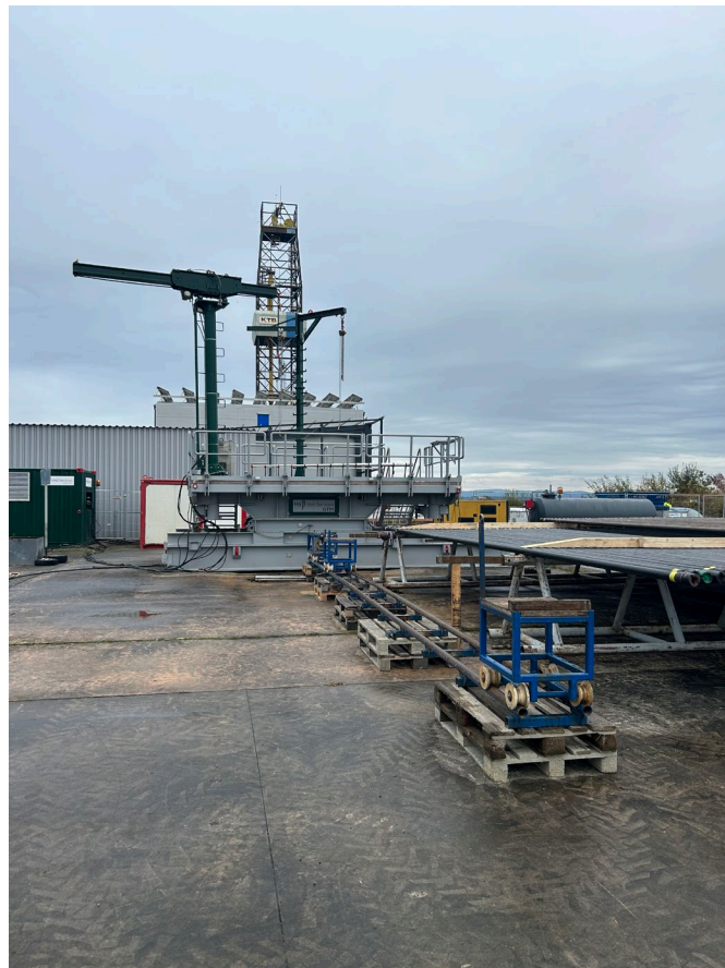
Bild 2: Für die Injektion werden Rohre in ein Bohrloch eingeführt und verschraubt. Dies geschieht mit einer Anlage, die „Pipehandler“ heißt. Foto: GFZ
